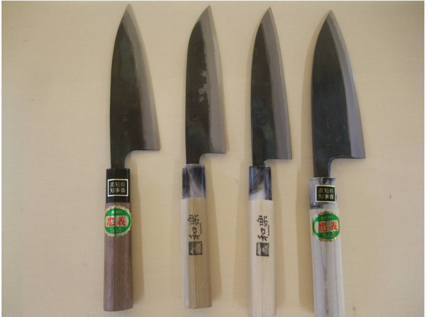
♪ いずれも刃渡り 5 寸(15 cm)の和包丁各種 左から舟行 土佐型 サバキ 出刃
